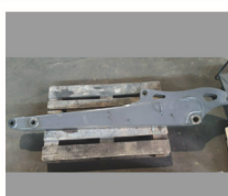
Löffelstiel kurz 1400 mm zu VOLVO ECR40D VOE1839327 Art. 10145
