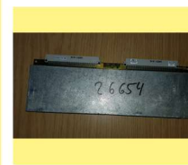
CPU Rechnerkarte für Theimeg Funk Easy Control Empfänger EC/30 100 x 270 x 18 Art. Nr. 26654
