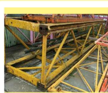
Turmschuss S10 Peiner Obendreherkran SK56 / SK70 / SK76 Länge 6 m BML-Nr. 8629
