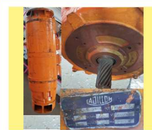
Hubmotor PATAY gebraucht A 132 M2 DPFCM V: 220/38 Hz: 50 für Cadillon 1120 Art-Nr. 10924
