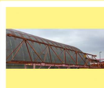
Ausleger Nr. 6 Länge 10 m Peiner Obendreherkran SK126 BML-Nr. 8010
