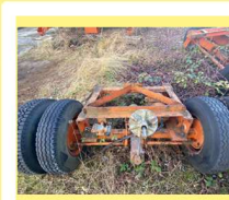
Untersetzachse UN8 Kranfahrwerk, 25 km/h B.J. 1979, Tragkraft 5500 kg Spurweite 1700
